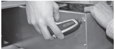
Schrauben der Motorbefestigung lösen.
