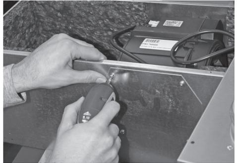
Motorkastendeckel wieder aufsetzen und festschrauben.
